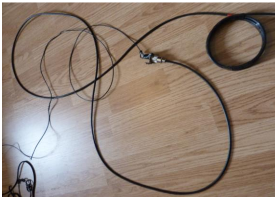
De bovenste straler heb ik gemaakt van een stukje zwart netsnoer van 1.30 meter wat ik gesplitst heb en in het midden aan elkaar is
