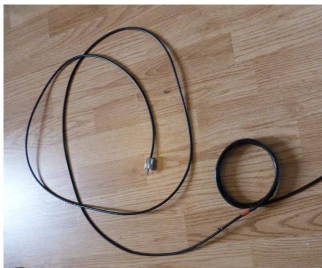
De bovenste straler heb ik gemaakt van een stukje zwart netsnoer van 1.30 meter wat ik gesplitst heb en in het midden aan elkaar is
